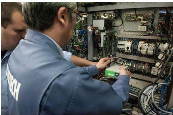
Service-Techniker von ACCRETECH integrieren die ATC-Steuerung bei Klingel in die Steuerung der Brother Fräsmaschine
