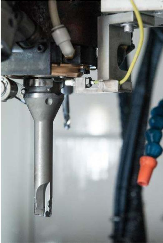
Der Sensor des ATC Rundlauf-Erkennungssystems. Bei einer Spindeldrehzahl von  $600 \text{ min}^{-1}$  dauern die Messungen gerade einmal  $0,3 \text{ s}$
