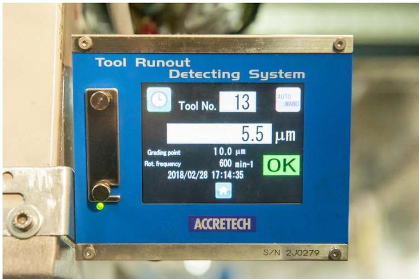
An dem, an der Fräsmaschine angebrachten, ATC Kontrollsystem werden die Rundlaufabweichungen der Werkzeuge angezeigt. Bei Überschreitung der eingestellten Toleranz wird der Bearbeitungsprozess unterbrochen.
