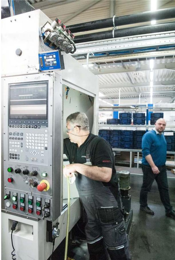
Ein Produktionsmitarbeiter beim Säubern der Fräsmaschine, in die das Inline-Messsystem ATC eingebaut ist. Oben links das blaue Kästchen ist das GUI des ATC
