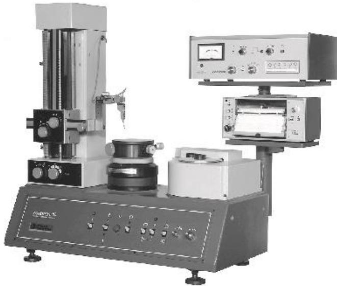
Figura 2 - ROND COM 5A, strumento di misurazione di rotondità e profilo cilindrico commercializzato nel 1979
