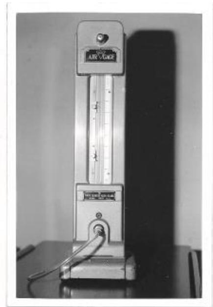
Figura 3 – 1952, Il primo micrometro ad aria del Giappone
