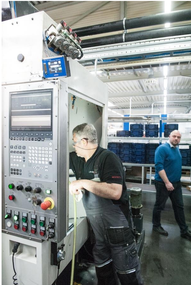
Un ouvrier de production nettoie la fraiseuse dans laquelle est installé le système de mesure en ligne ATC. La boîte bleue dans le coin supérieur gauche est l'interface graphique de l'ATC
