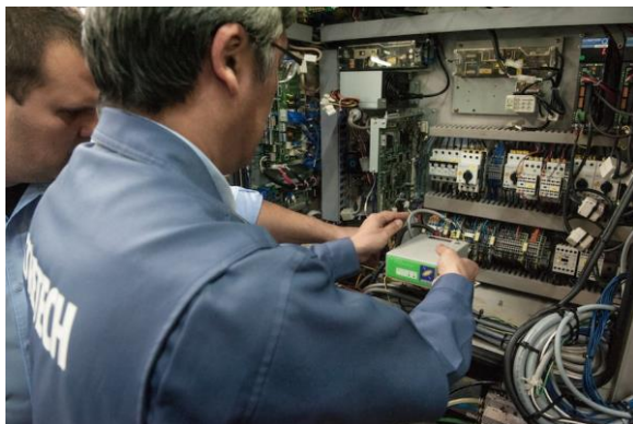
Les techniciens de service d'ACCRETECH intègrent la commande ATC de Klingel dans la commande de la fraiseuse Brother
