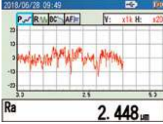
Yüzey pürüzlülüğü (Ra) ölçümü örneği
